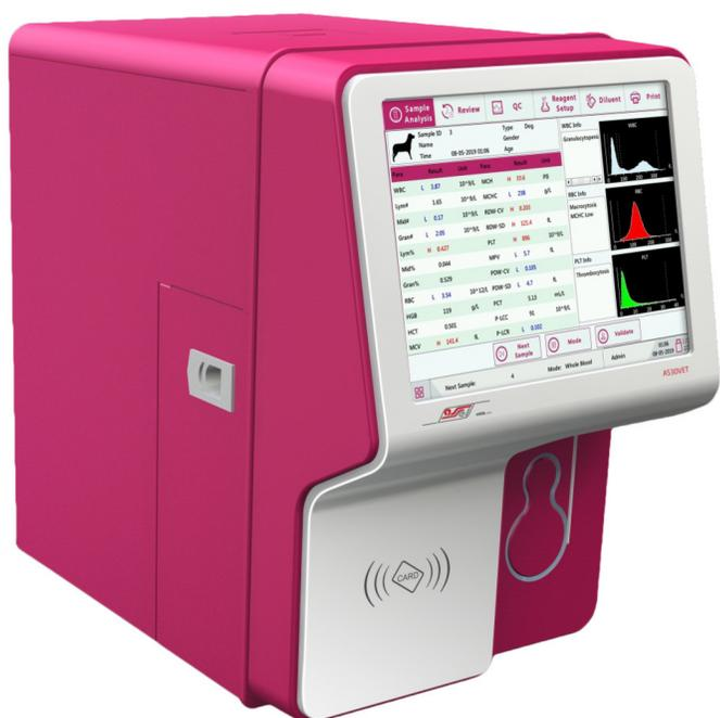
AS30 VET è un innovativo analizzatore ematologico a 3-diff con: 60 campioni/ora, LYSE e DILUENTE sviluppati appositamente testati per funzionare perfettamente con la macchina e fornire risultati accurati all'utente, anche in test con basso PLT.
